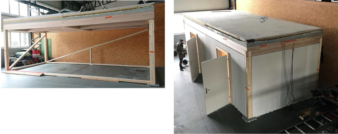
Abbildung 8: Versuch Deckenelement mit unterschiedlichen Bodenaufbauten und Wohnungstrennwandtypen beziehungsweise -anschlüssen
