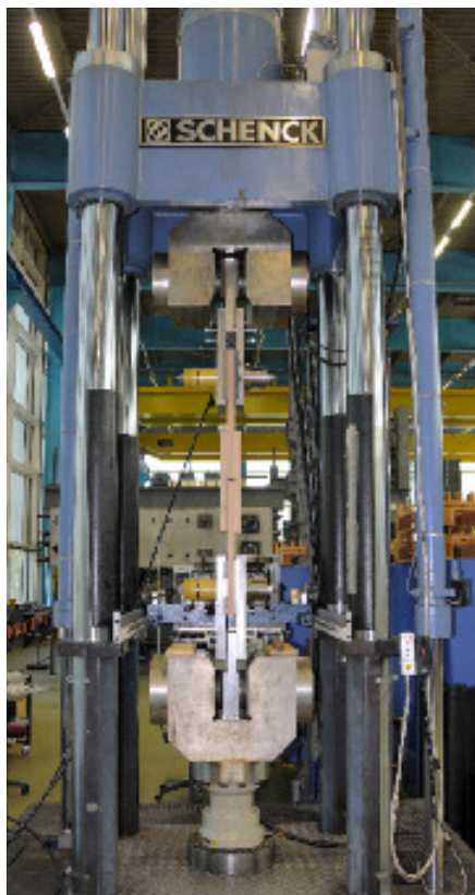
Vorversuche an Lamellenstössen (links) und an einem Auflagerbereich (rechts).
