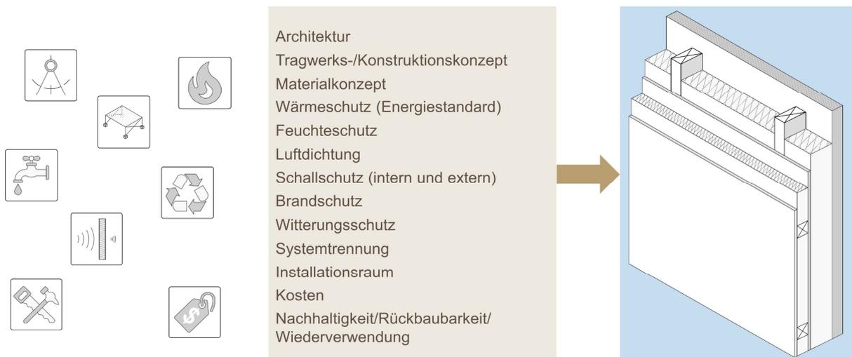
Abb. 1: Anforderungen an Aussenwandkonstruktionen ([1] modifiziert)
