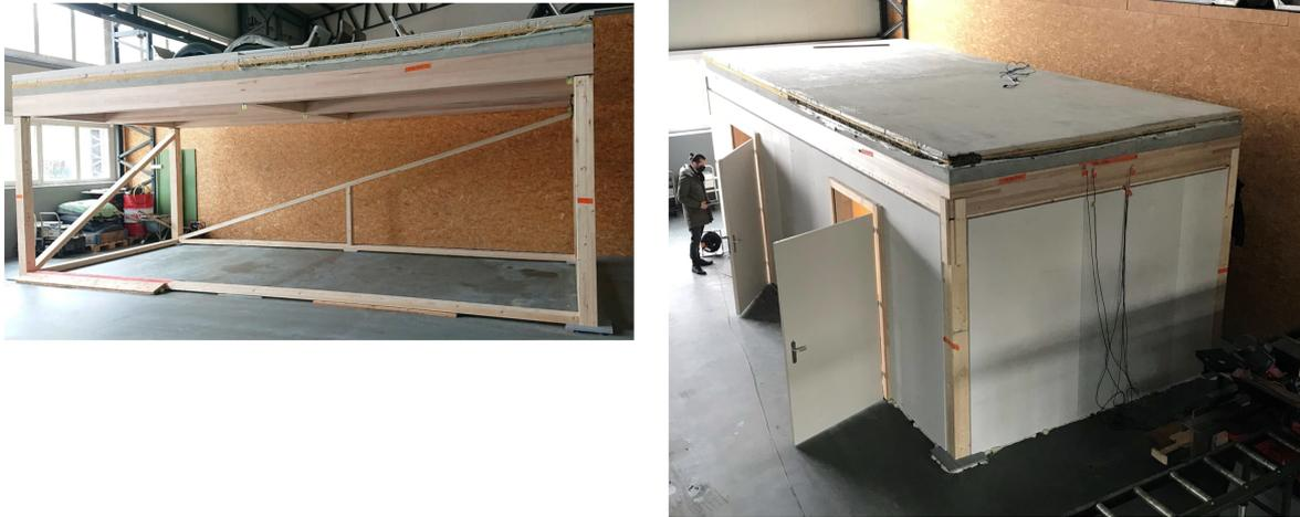
Abbildung 6: Versuch Deckenelement mit unterschiedlichen Bodenaufbauten und Wohnungstrennwandtypen beziehungsweise -anschlüssen
