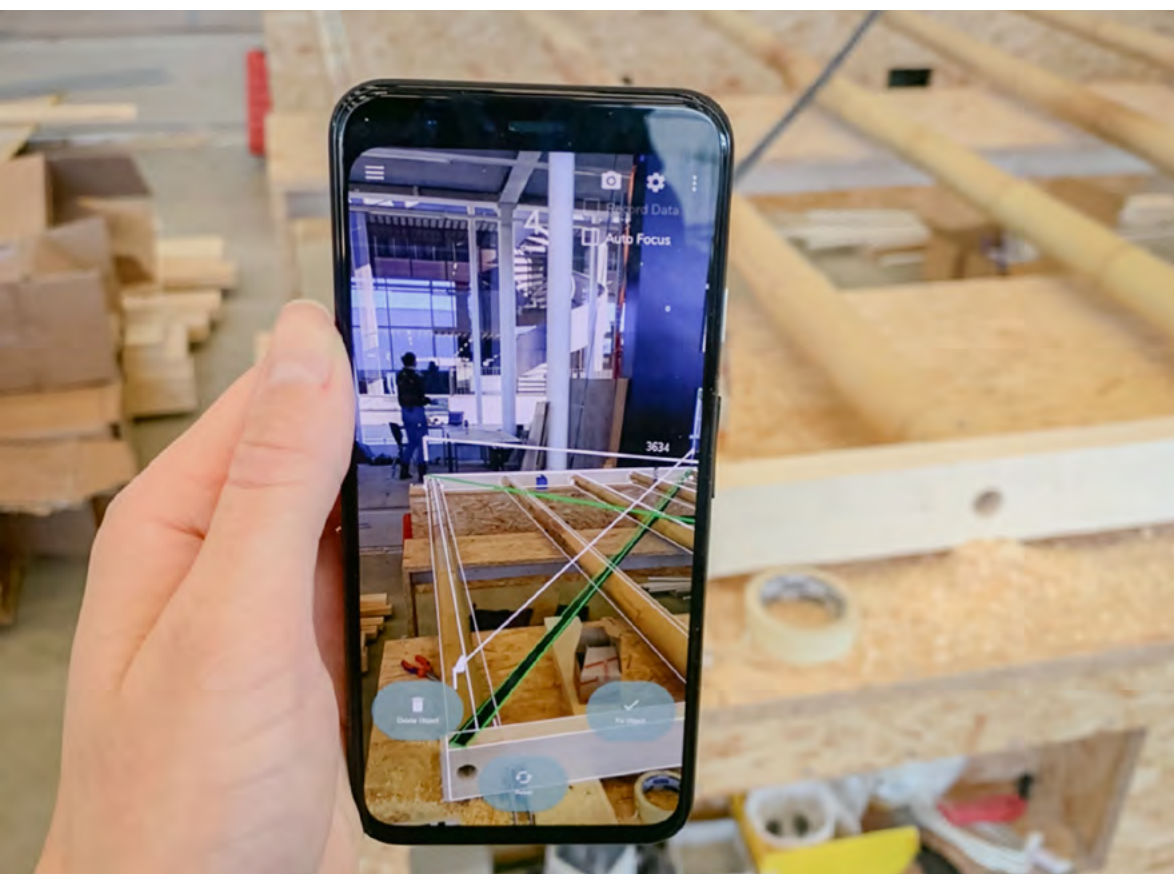
Exakte Überlagerung des vorliegenden Holzrahmenelements mit der Schritt-für-Schritt-Anleitung in der App von incon.ai Bild: incon.ai
