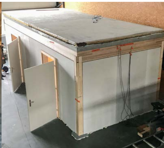
Hochhaus H1 Zwhatt-Areal Regensburg, Versuchselement Decke für Verformungs- und Schallschutzmessungen
