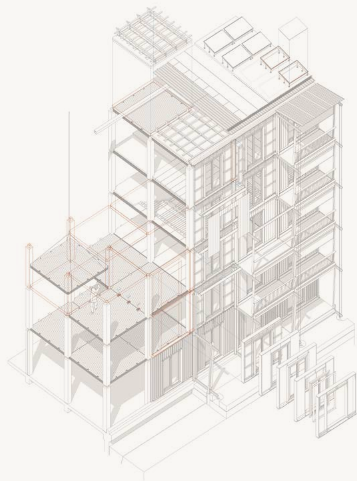
Hardstrasse Birsfelden, Grundriss 1:200 und 1:50 (Ausschnitt) sowie Konstruktionsaxonometrie Bilder: Jaeger Koechlin, Basel
