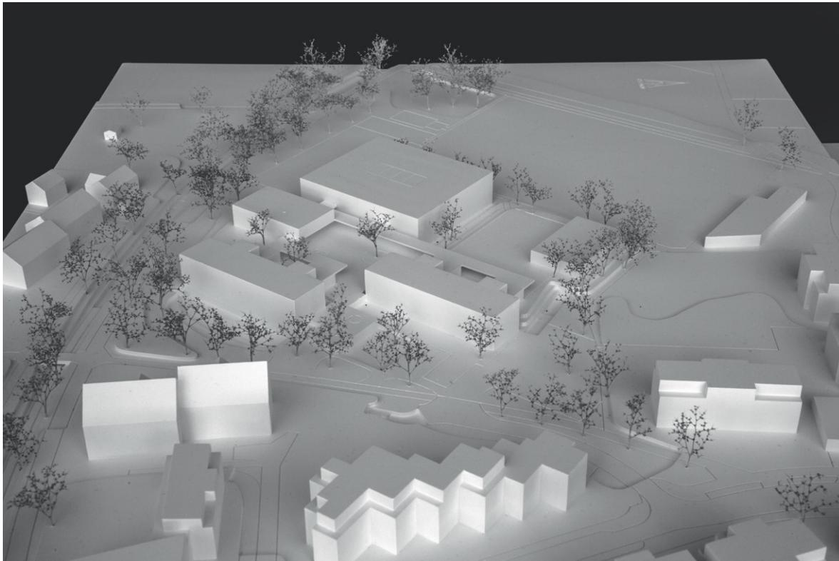
Erklärtes Ziel des Projekts ist der Verzicht auf einen grossmassstäblichen Ergänzungsbau. Wie bei anderen Beiträgen wird deshalb eine Aufstockung auf die zur Dreifachhalle vergrösserte Turnhalle vorgeschlagen. Als zweite Massnahme wird in der nordöstlichen Ecke der Parzelle ein pavillonartiger, eingeschossiger Neubau vorgesehen, welcher als Kindergarten dient. Die anderen bestehenden Gebäude bleiben – bis auf den Treppenhausanbau für Aufzug und Hauswartsraum – äusserlich unverändert.
