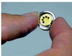
Druckabnehmer mit integrierter Messzelle. Foto: M. Dahinden
