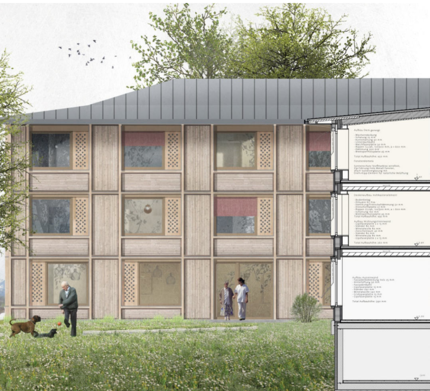
Konstruktionsschnitt und Fassade
